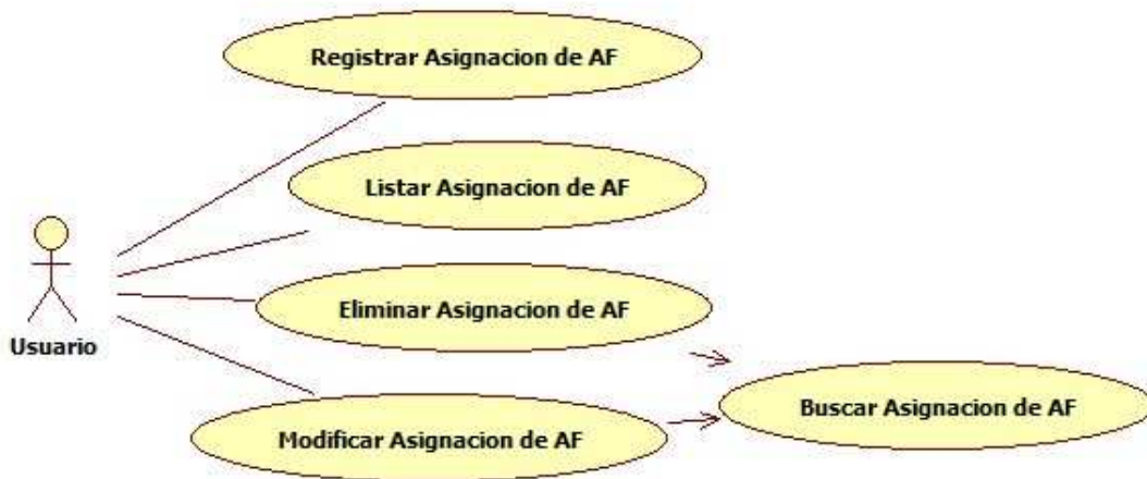
Figura 25 Estructura de caso de uso para Asignación de Activo Fijo. AF (Activo Fijo).
